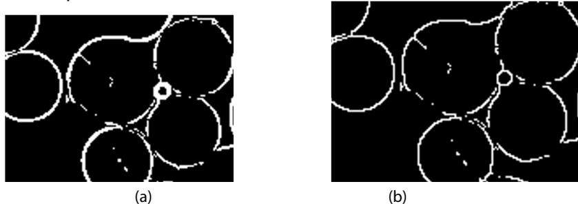
**Figura 16:** Corte em imagem orbital na qual se aplicou o Detector de Bordas de Sobel e, logo em seguida, uma Limiarização pelo Método de Otsu (a) e aplicação do Afinamento Morfológico (b)
