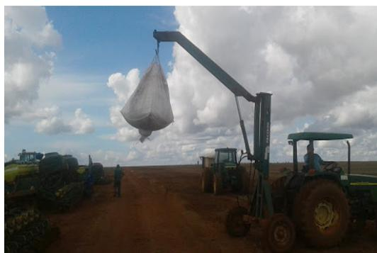
Figura 15 - Trator transportando sementes em Bag para reabastecimento de plantadeira. UP Guapirama
