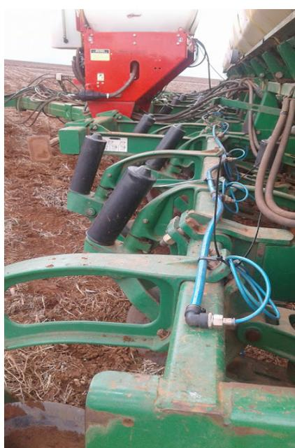
Figura 42 - Distribuição dos bicos de aplicação do nematicida junto as linhas de plantio de algodão. UP Guapirama
