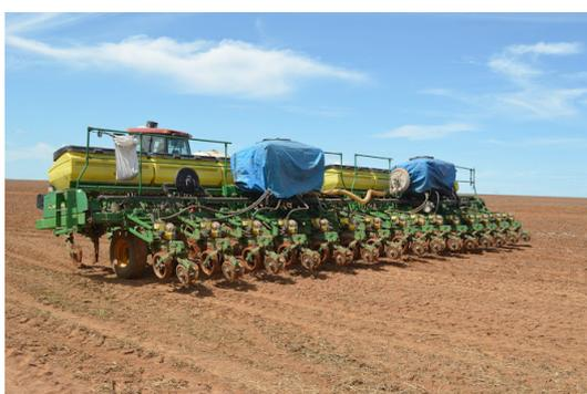
Figura 52 - Plantio. Detalhe das turbinas cuja função é promover a distribuição, o mais uniforme possível, das sementes no sulco de plantio. UP Guapirama 12/01
