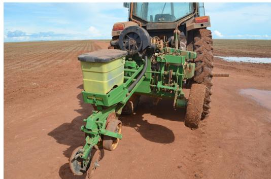
Figura 86 - Plantadeira de uma linha utilizada na operação de replantio realizado em todos os talhões que apresentam falhas na germinação. UP São José
