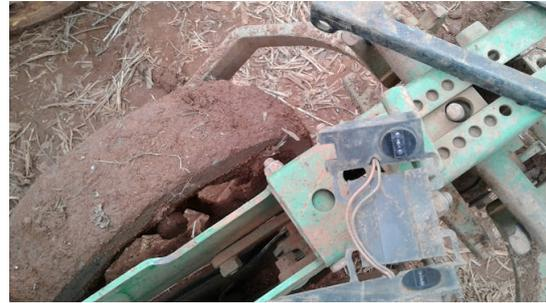
Figura 63 - Sensores que quantificam o número de sementes que chegam ao solo
