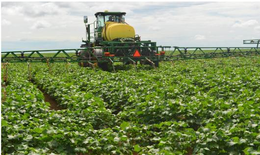
Figura 113 - Equipamento para pulverização em jato dirigido. UP Ribeiro do Céu
