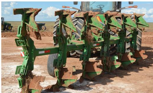
Figura 2 - Arado de aiveca utilizado para o preparo do solo até a profundidade de 40 cm. UP Ribeiro do Céu
