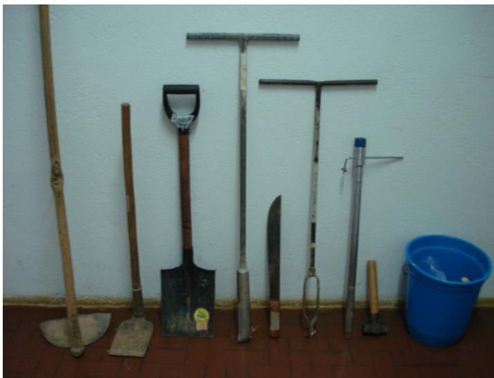
**Figura 6.1.** Instrumentos que podem ser utilizados para a coleta de amostras de solo para análises laboratoriais. Da esquerda para a direita: enxada, enxadão, pá reta, trado tipo caneca, facão, trado holandês, trado tipo sonda, marreta, balde para coleta e homogeneização das amostras simples e sacos plásticos (dentro do balde) para acondicionar as amostras compostas. Foto: Mario Puiatti
