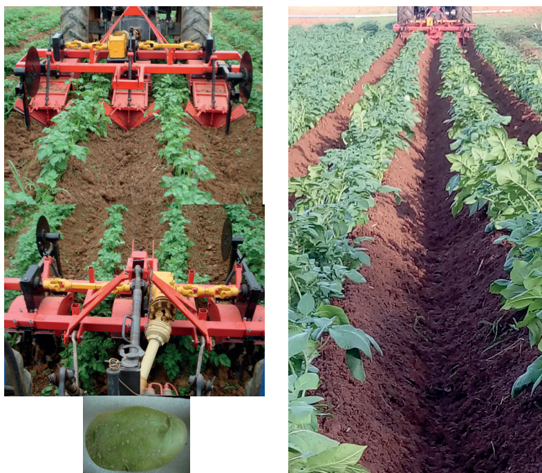
Figura 9.8. Detalhes do implemento “frezadora”, tracionado por trator, em operação realizando a amontoa em batateira e de tubérculo de batata com esverdeamento devido exposição à luz a solar. Fotos: Mario Puiatti
