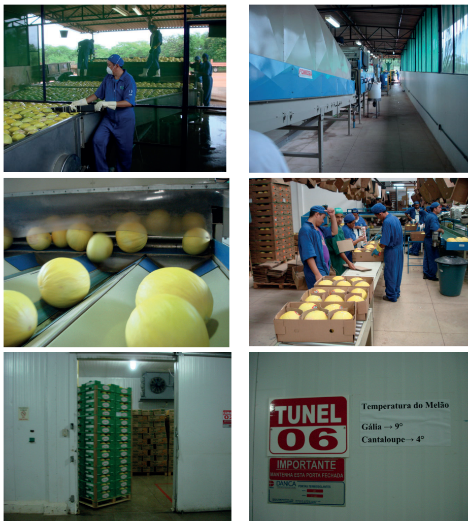
Figura 10.12. Melão produzido por empresa privada em Mossoró, RN. Da esquerda para a direita: no alto, tanque com água e detergente para a recepção dos frutos e máquina de higienização. Centro, saída dos frutos da máquina de lavagem e higienização, classificação, embalagem e identificação dos frutos. Abaixo, paletização das caixas e armazenamento em câmara fria de melão destinado à exportação, com detalhe da temperatura de armazenamento para cada tipo de melão. Fotos: Mario Puiatti
