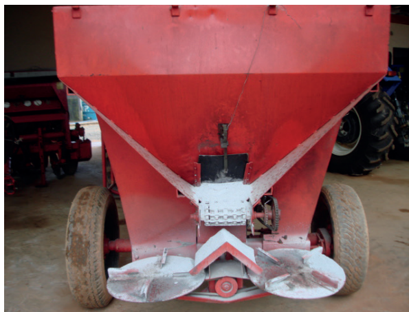
Figura 6.2. Modelo de implemento utilizado na aplicação de calcário (calagem). Foto: Mario Puiatti
