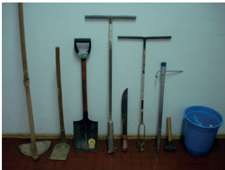
Figura 6.1. Instrumentos que podem ser utilizados para a coleta de amostras de solo para análises laboratoriais. Da esquerda para a direita: enxada, enxadão, pá reta, trado tipo caneca, facão, trado holandês, trado tipo sonda, marreta, balde para coleta e homogeneização das amostras simples e sacos plásticos (dentro do balde) para acondicionar as amostras compostas. Foto: Mario Puiatti
