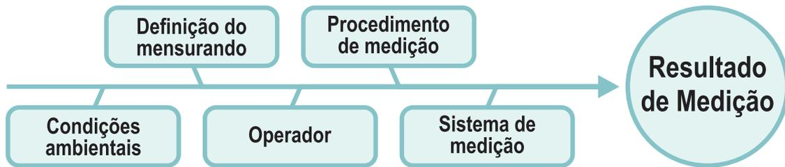
Figura 1 - Elementos do processo de Medição
