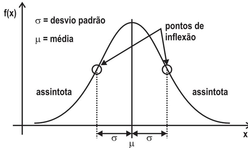
Figura 7 - Função de distribuição de probabilidade Normal.
