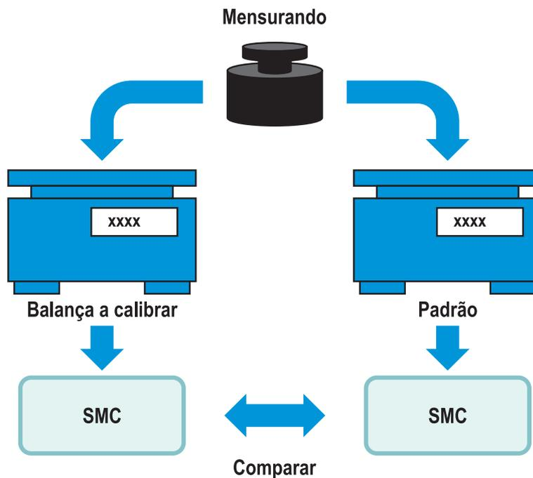
Figura 4 – Exemplo de Calibração Indireta (Balança)
