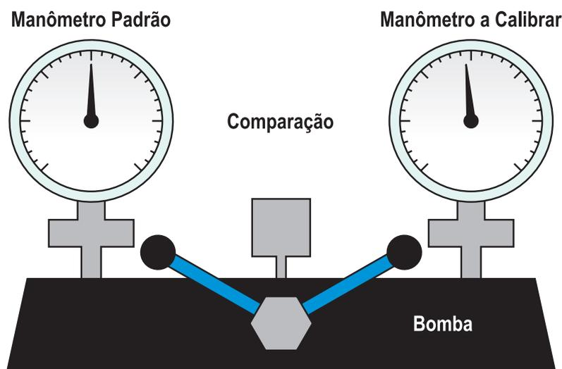
Figura 5 – Exemplo de Calibração Indireta (Manômetro)
